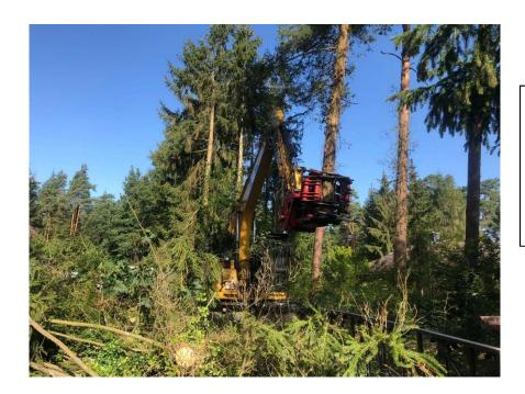
Durch leistungsstarke Technik ist das Fällen von Bäumen auf engsten Raum mithilfe des Baggers und Schnittgreifers sicher durchzuführen.
