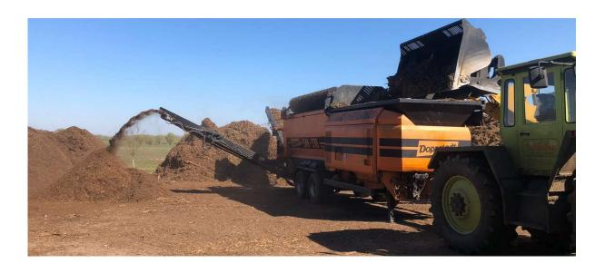
Durch das Sieben von Schüttgütern ist die Herstellung verschiedenster, vermarktungsfähiger, Fraktionen eine schnelle und effiziente Lösung.
